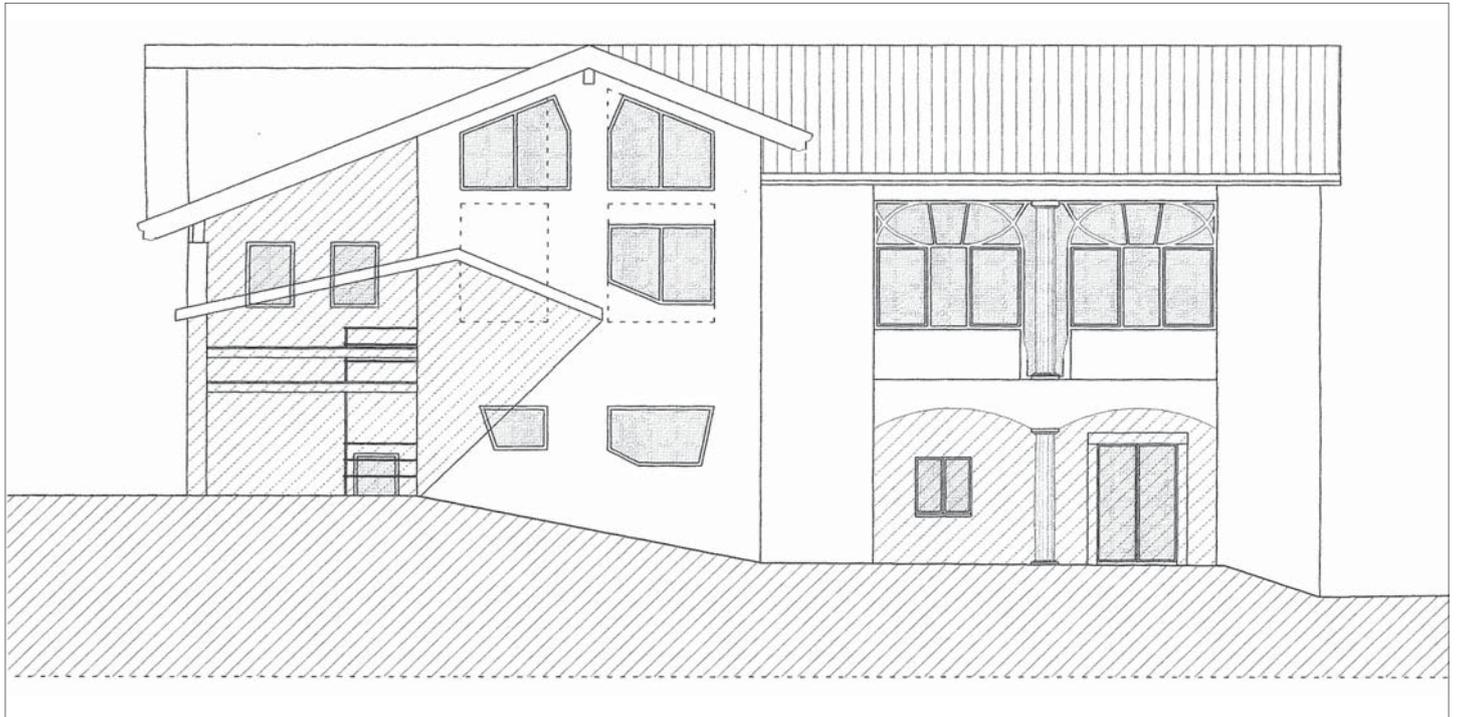
FIGURA 11. Vista sud del rustico con sezione della tettoia di raccordo con il nuovo forno.
